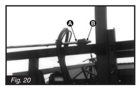
1. Loosen jam nut (A)(Fig. 20).
